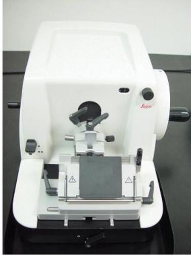
**Fig 3.** 회전식 박절기 (rotary microtome)
