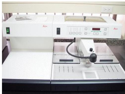
**Fig 2.** Embedding center: 파라핀 블록 제작 기기
